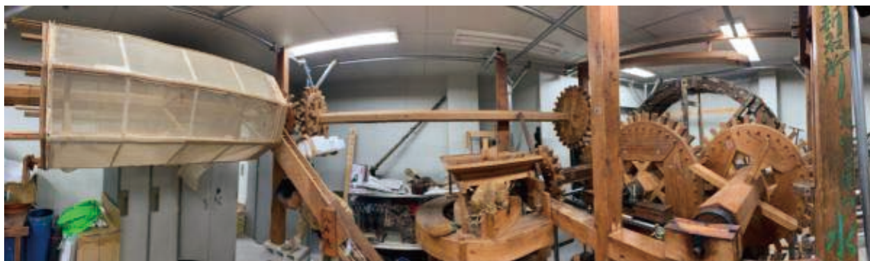
大黒屋本店から京都大学宇治川オープンラボラトリーに移設した粉挽水車装置 (右奥上方に樋、その下が水車、その手前が木製ギヤ、右柱の陰に搗き臼、中央手前が挽き臼、その左がロープコンベア、左端上方が布製回転ふるい)
